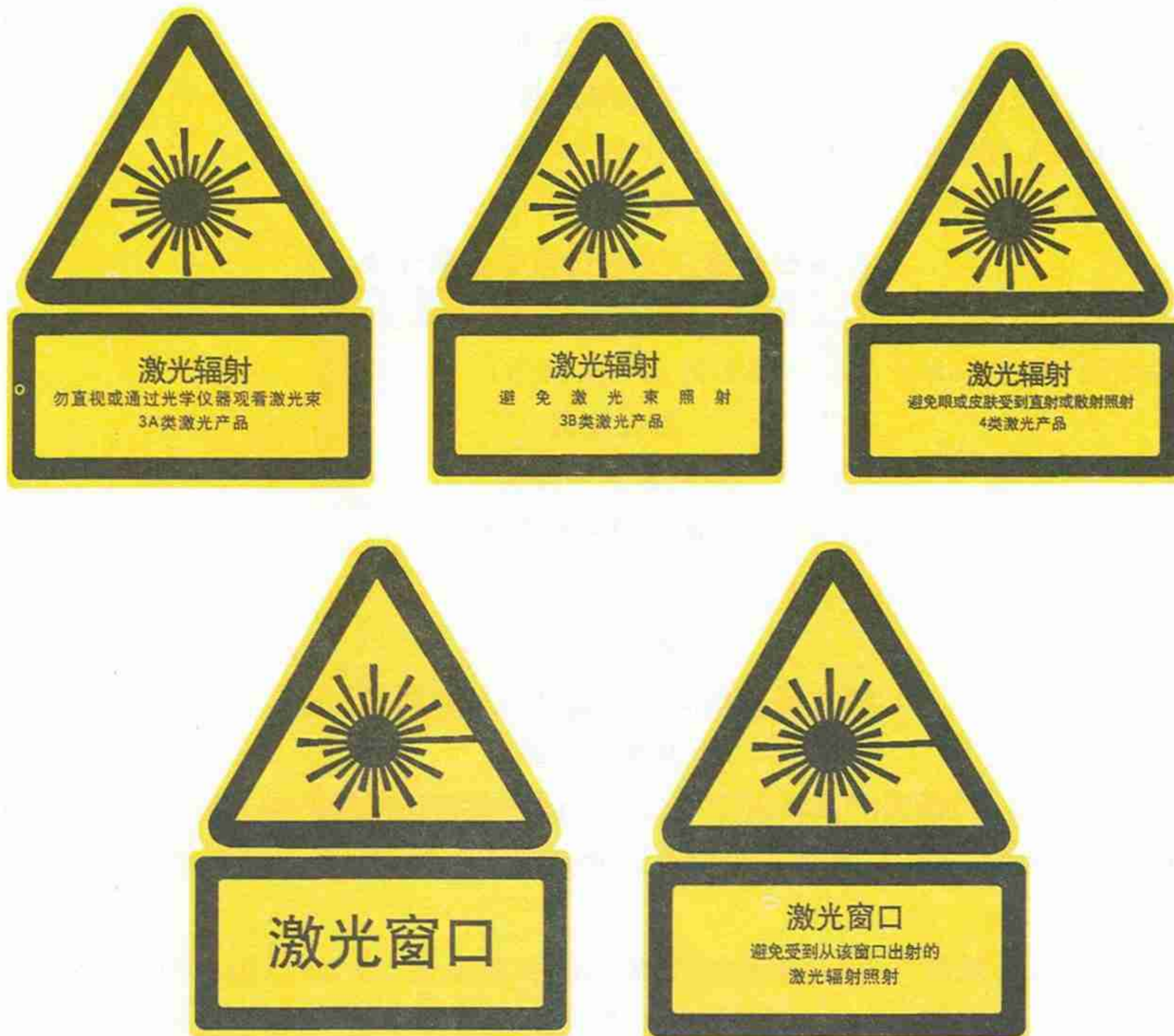
图 C.2 激光产品安全标志使用实例
